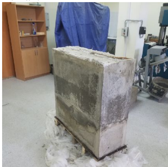
Рис. 8. Процесс изготовления макета наружной стены экспериментального здания
